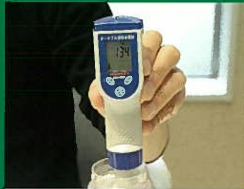
測定器：TRUSTLEX製ポータブル溶存水素計
